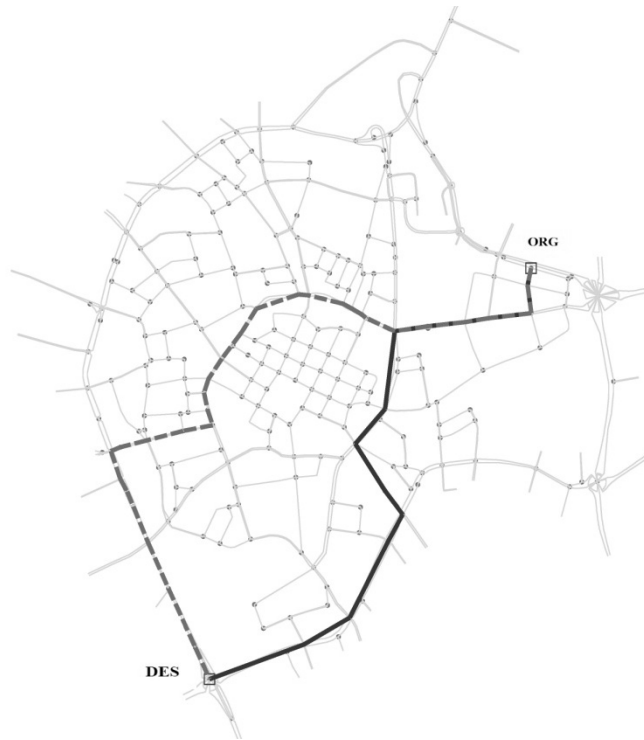
Rys. 2. Najkrótsza ścieżka na podstawie modelu deterministycznego (DET) – linia ciągła oraz wersji odpornej (ROB) – linia przerywana
