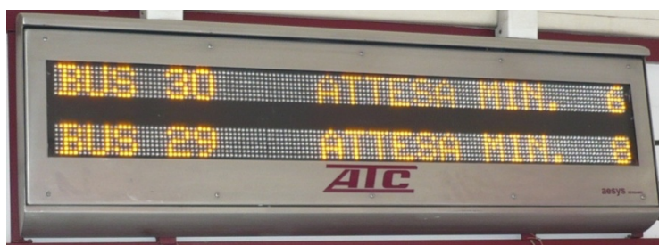
Rys 3. Przykładowa tablica przystankowa zmiennej treści
