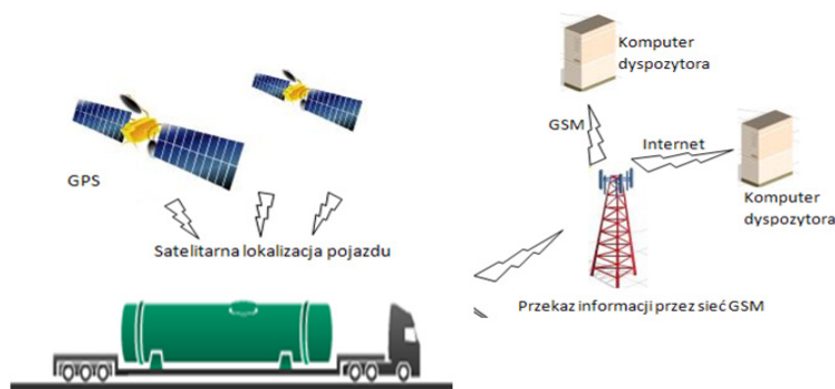
Rys. 7. Systemy telematyczne transportu – zasada działania systemu do monitorowania przewozu ładunków
